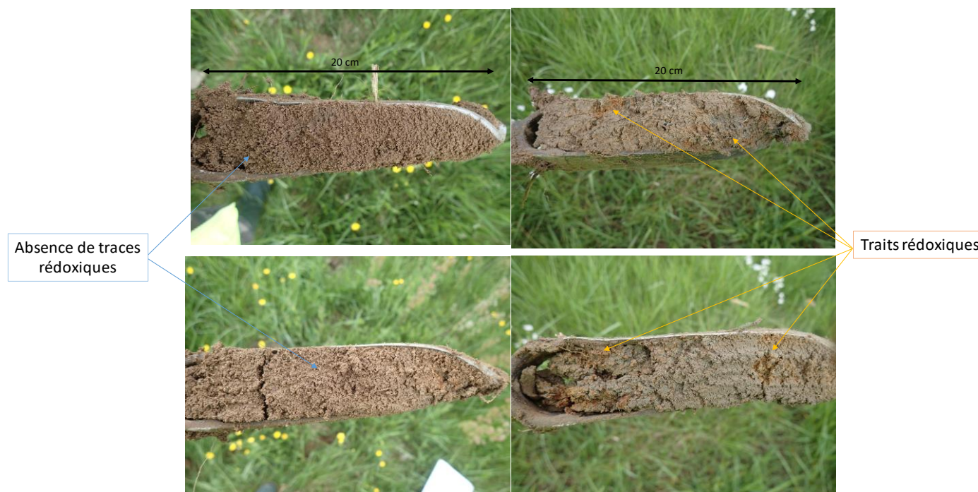
Figure 21 : Exemple de sondages pédologiques
